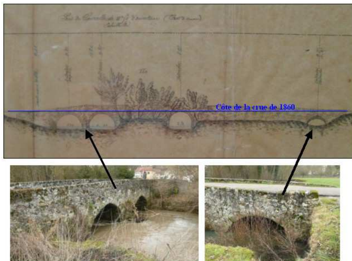
Illustration 5 : Exemple de repère de crue extrait des archives (crue de 1860 sur le pont de Courcelles)
